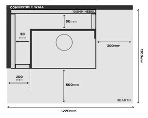
\*\*\*HEARTH MUST BE A MINIMUM OF 150MM THICK
