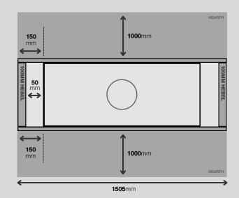
HEARTH MUST BE A MINIMUM OF 30MM THICK AT A 300MM ELEVATION
