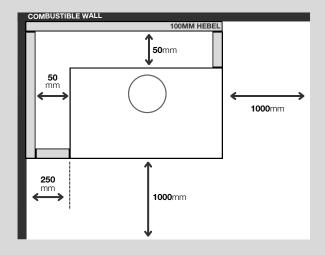
HEARTH MUST BE A MINIMUM OF 30MM THICK AT A 300MM ELEVATION
