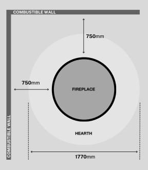
HEARTH MUST BE A MINIMUM OF 40MM THICK
